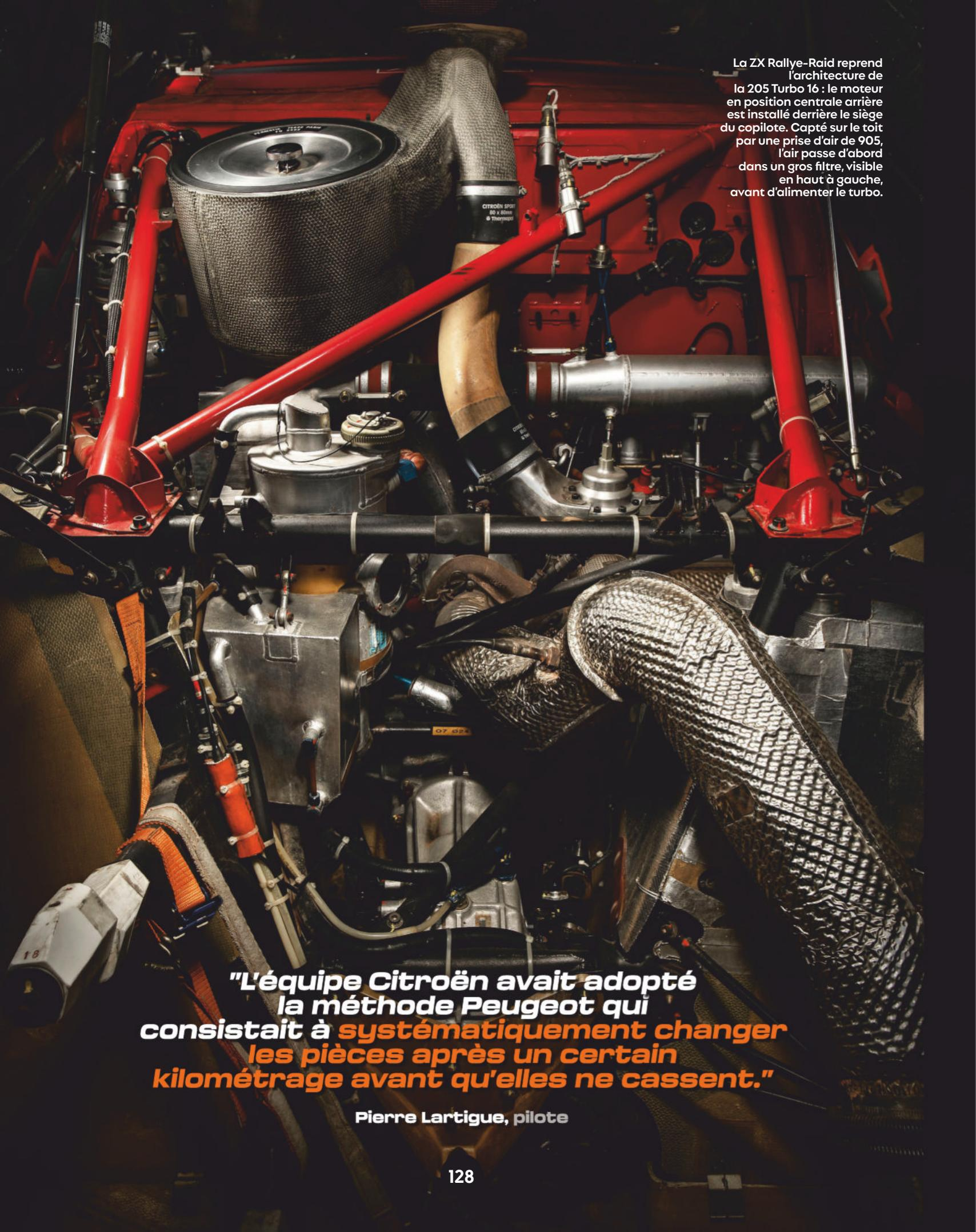
La ZX Rallye-Raid reprend l'architecture de la 205 Turbo 16 : le moteur en position centrale arrière est installé derrière le siège du copilote. Capté sur le toit par une prise d'air de 905, l'air passe d'abord dans un gros filtre, visible en haut à gauche, avant d'alimenter le turbo.
