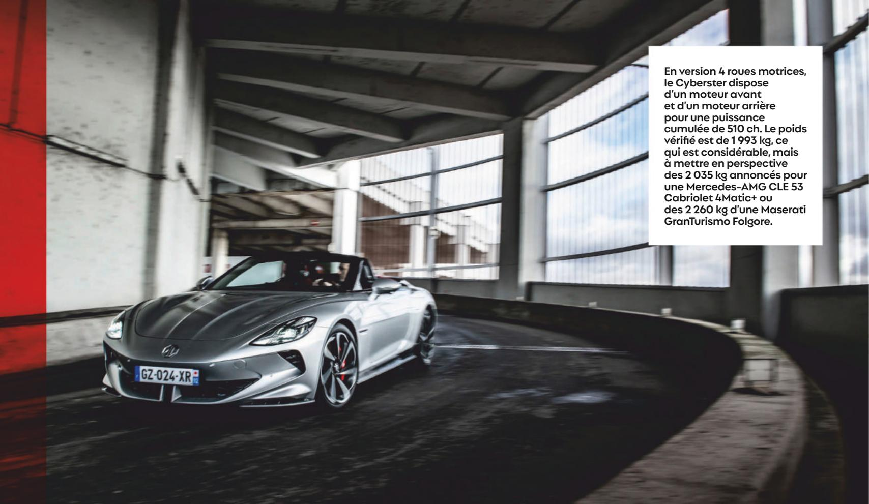
En version 4 roues motrices, le Cyberster dispose d'un moteur avant et d'un moteur arrière pour une puissance cumulée de 510 ch. Le poids vérifié est de 1993 kg, ce qui est considérable, mais à mettre en perspective des 2 035 kg annoncés pour une Mercedes-AMG CLE 53 Cabriolet 4Matic+ ou des 2 260 kg d'une Maserati GranTurismo Folgore.
